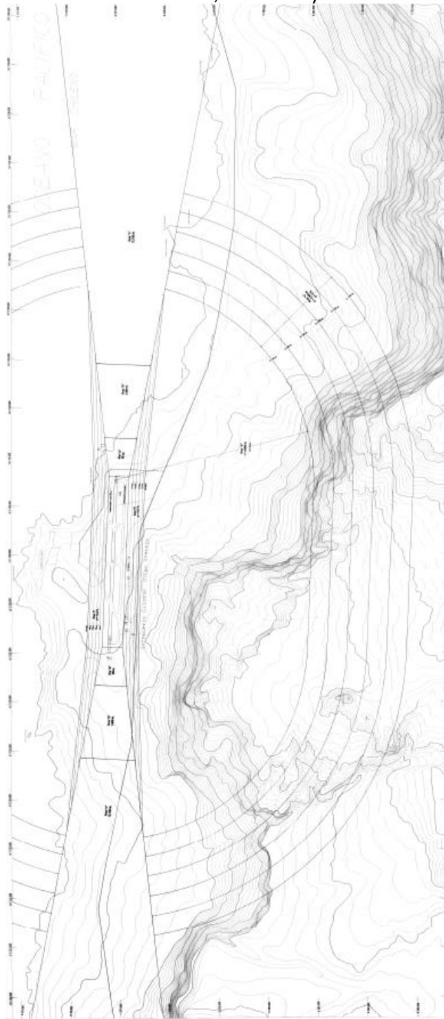
Ilustración 2-54 Plano de protección aeropuerto “Diego Aracena y sus radioayudas”, Iquique (Plano PP-05-02, Marzo 2005)
